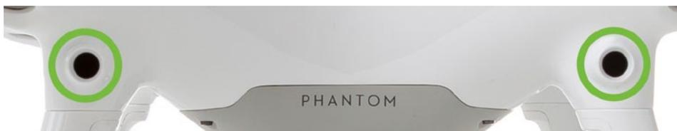
*Abbildung 2-4: Front-Kameras zur Kollisionserkennung*
