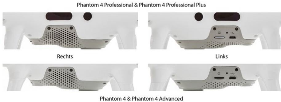
Abbildung 2-12: Fehlende Sensoren machen den Phantom 4 Pro und Phantom 4 Advanced unterscheidbar.
